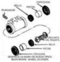
Funcionamiento: el sistema de frenos de tambor ocupa para su funcionamiento, un pequeño cilindro llamado, cilindro de rueda. [wheel cylinder brake].
