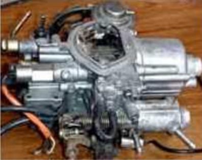
En la fotografía, observamos un carburador con solenoides, que se activan electrónicamente.
