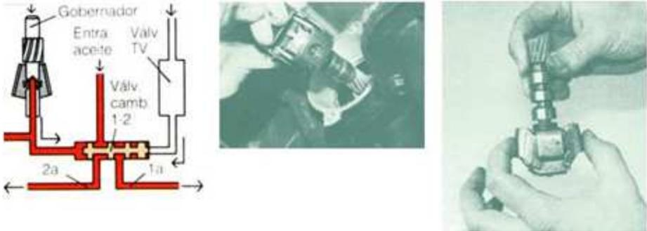
Aquí tenemos el componente llamado gobernador; este gobernador por lo regular va instalado en la flecha de salida. En algunas transmisiones como en la que se ve en la ilustración,; removerlo es fácil, en otras se ocupa remover algún componente adicional para facilitar el acceso.
