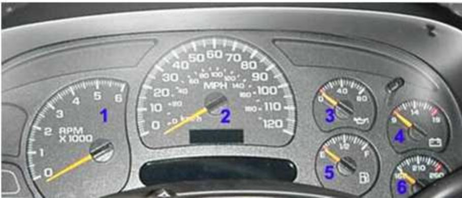
1) Tacómetro. Este reloj indica las revoluciones del motor en funcionamiento, aún con el vehículo detenido. Es importante tomar nota de este indicador, debido a que normalmente las revoluciones deben subir a un promedio de 3,000 RPM. Si usted observa que esta aguja sube y se mantiene arriba de este promedio, debe llevarlo al taller de mecánica para descartar problemas de motor o transmisión.
