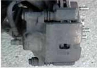
Aquí estamos presentado un caliper o mordaza de frenos del tipo deslizante. Para desmontar este caliper solo se necesita retirar el perno inferior y levantarlo, deslizando de la guía superior.
