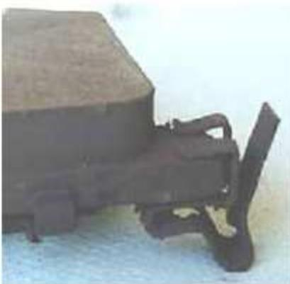
Aqui tenemos un sensor típico de pastilla de frenos. Cuando cambiamos las pastillas, una de ellas o las dos lleva colocado este tipo de sensor, que debe ser regulado.
