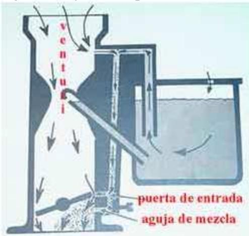
Cuando el aire pasa por el venturi, disminuye su presión y succiona gasolina de la taza del flotador; si el papalote del acelerador, está muy abierto entra aire rápidamente y al disminuir la presión de aire, entra más gasolina ..
