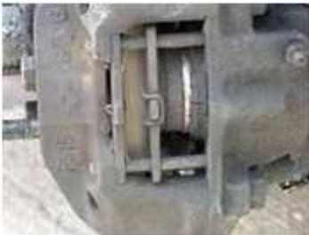
Aquí podemos apreciar el caliper o mordaza, el pistón y las dos pastillas totalmente gastadas, presionando al rotor.
