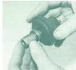
A este componente se le conoce como modulador. Este componente es activado por vacío o vacuum, para ello le llega una manguera desde el manifold de admisión.
